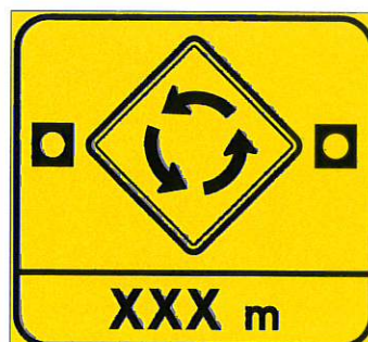
Figure 8.6-1 Exemples de renforcement du message d'un panneau
