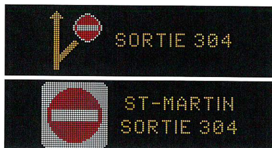
Figure 8.16-7 Exemples de bretelle ou de route fermée en aval
