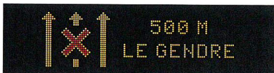
Figure 8.16-6 Exemple de voie centrale fermée en aval
