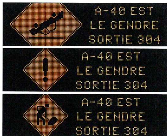
Figure 8.16-11 Exemples de présence d'un accident, d'un incident ou de travaux sur une autre route
