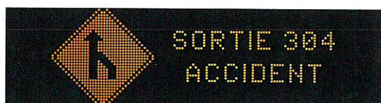
Figure 8.16-5 Exemple de voie fermée en aval
