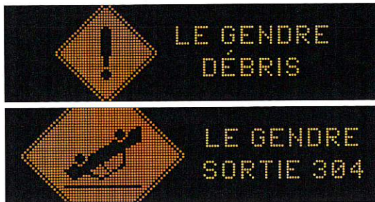
Figure 8.16-8 Exemples de présence d'un accident ou d'un incident en aval
