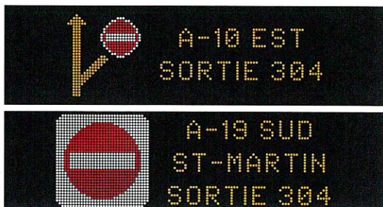
Figure 8.16-10 Exemples de route ou de bretelle fermée sur une autre route
