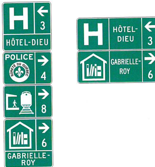
Figure 5.6-3 Modèles de regroupement de panneaux d'équipements
