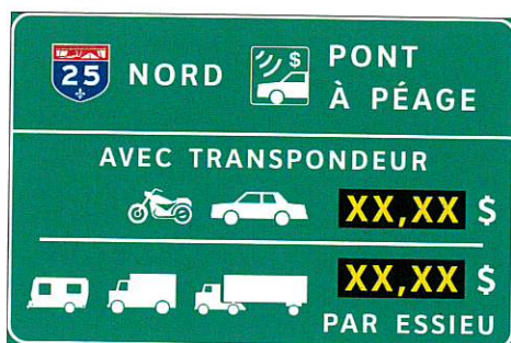
Figure 5.7-1 Exemples de panneaux d'indication utilisés pour signaler une infrastructure routière sur laquelle un système de péage est appliqué
