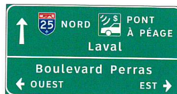
Figure 5.7-1 Exemples de panneaux d'indication utilisés pour signaler une infrastructure routière sur laquelle un système de péage est appliqué
