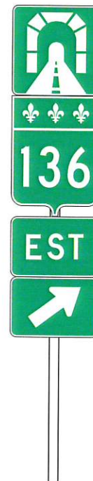
Figure 5.5-2 Installation du panneau « Tunnel » et du panneau d'indication d'un chemin sur un même support
