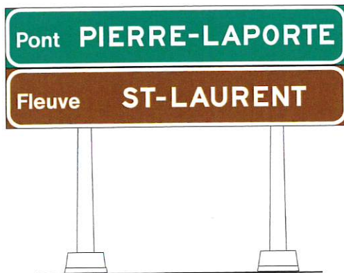
Figure 5.5-4 Installation des panneaux « Nom de pont » et « Élément hydrographique » sur un même support
