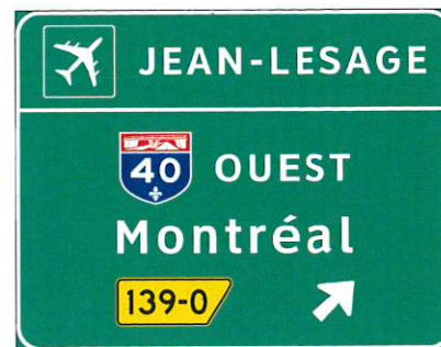
Figure 5.4–10 Exemple d'utilisation du module d'aéroport
