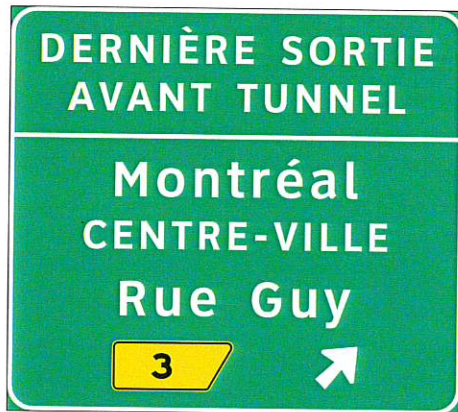
Figure 5.4–12b Exemple de panneau portant le message « Dernière sortie avant tunnel »
