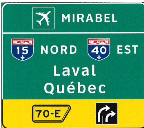
I-75-2 Panneau de direction de sortie
