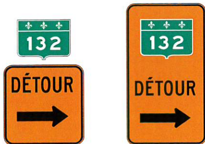
Figure 4.20-2 Montage avec les panneaux « Détour »
