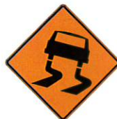
T-D-310-1 Chaussée glissante
