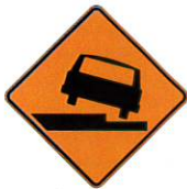
T-140-2 Présence d'une dénivellation
