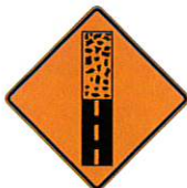
T-D-350 Fin du revêtement
