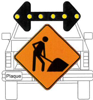
Figure 4.39-1 Montage de panneaux installés sur les véhicules d'accompagnement
