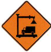
T-50-5 Poste de contrôle du transport routier temporaire
