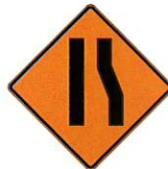
T-D-210-2-D Chaussée rétrécie
