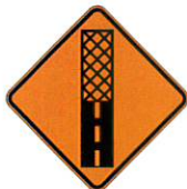
T-D-340 Changement de l'état d'une chaussée
