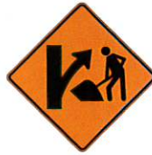
T-50-11-D Zone de travaux dans une sortie
