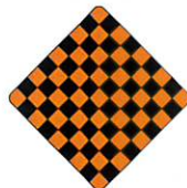
T-D-280 Fin d'une voie ou d'un chemin
