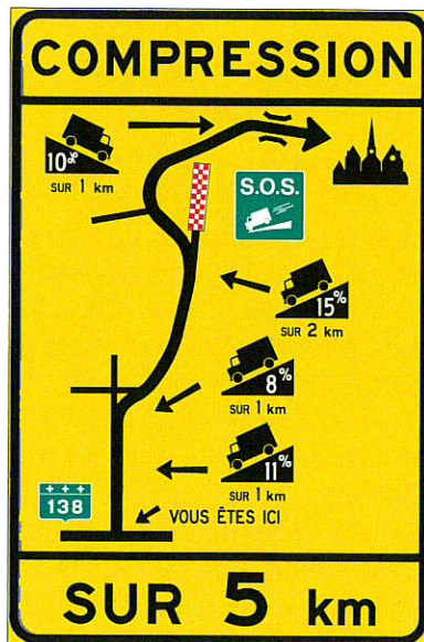
Figure 3.27-2 Exemple de panneau indicatif
